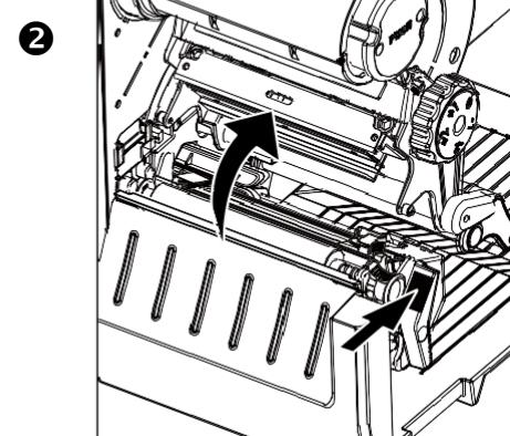
Loading Media/安装標籤/安装标签/メディアの読み込み/Загрузка носителя/ Medien werden geladen/Chargement des medias/Cargando medios/Caricamento dei media/حِمْلُ الْوَسَاطَة/حمّل الوساطة
